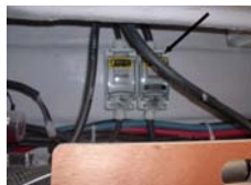
Disjoncteur 220V Implantation : Coffre arrière bâbord
