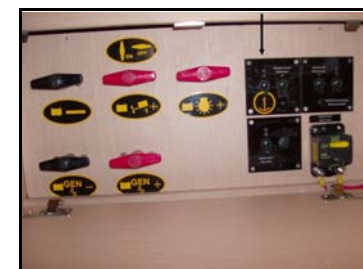
DISJONCTEUR DU GUINDEAU - 100A Cabine arrière bâbord
