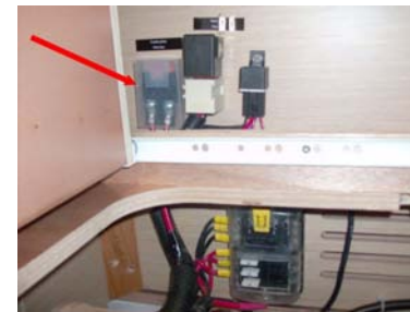
Implantation : Cabine arrière bâbord Pilote automatique - (60A)
