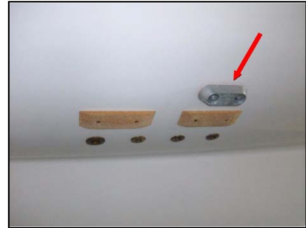
ANODE (sur coque, sous ligne de flottaison)
