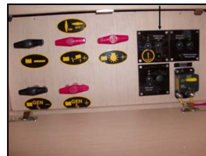
DISJONCTEUR 100A (WINCH ÉLECTRIQUE DE BOSSOIRS - OPTION)
