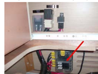
Implantation : Cabine arrière bâbord (Sous le lit) Pompe - WC électrique (25A)
